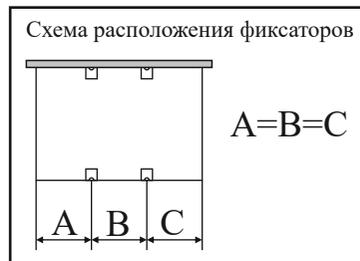
В накладку ящика вворачивается дюбель эксцентриковой стяжки. Ящик складывается согласно схеме, в паз вставляется дно, накладка стягивается с корпусом ящика. **Предварительно просверлив отверстия Ø 2,5 мм**, крепятся направляющие шурупами 4x13. Шурупом 4x16 через фиксатор приворачиваем дно ящика (рис. №5)
