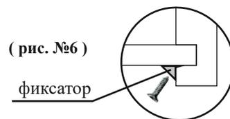
Схема расположения фиксаторов
