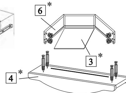
В накладку ящика вворачивается дюбель эксцентриковой стяжки. Ящик складывается согласно схеме, в паз вставляется дно, накладка стягивается с корпусом ящика. **Предварительно просверлив отверстия Ø 2,5 мм**, крепятся направляющие шурупами 4x13. Шурупом 4x16 через фиксатор приворачиваем дно ящика (рис. №6)
